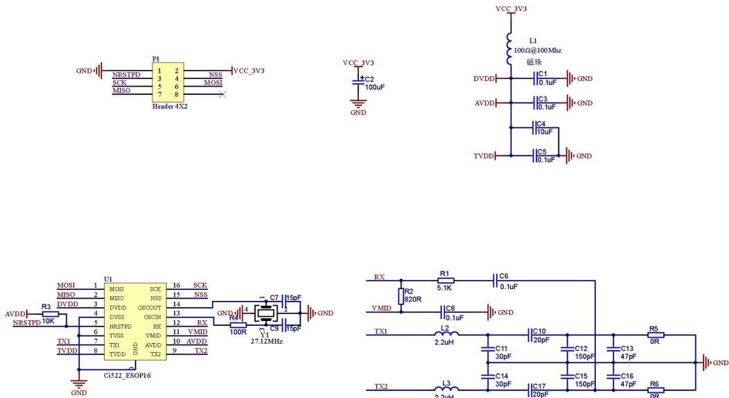
图 10-4 典型应用原理图(ESOP-16 封装)
