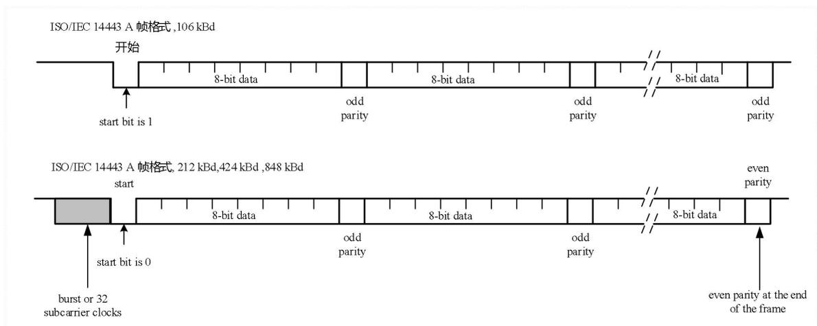
图 7-1 ISO/IEC 14443 A 协议下的数据编码和帧格式
